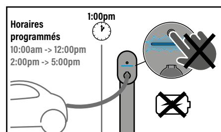
La dérogation sur le bouton en face avant ne permet pas de lancer la charge de véhicule en dehors des horaires programmés
