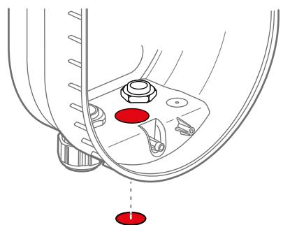
**Dans le cas d'arrivée de câbles par l'arrière ou pour un montage sur pied** (voir étapes de montage dans notice), il est nécessaire d'enlever les presse-étoupes fixés sur la borne, et d'obturer ces entrées avec les embouts passe-fil (fournis avec le pied, ou réf. 0 019 55). Il est alors nécessaire de percer les entrées de câbles arrière (non défonçables) avec un foret étaqué.
