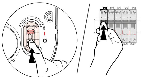
1. Mettre sous tension le circuit dans le tableau et dans la borne de recharge (dans le cas de borne de recharge avec protection intégrée).
