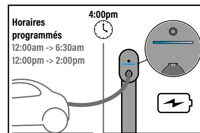
Il est possible de forcer la charge en dérogeant par un appui long sur le bouton en face avant de la borne de recharge ou via l'App. Home + Control
