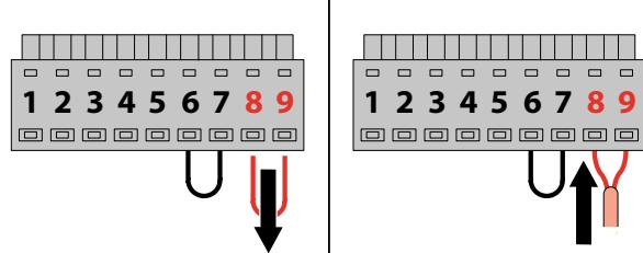
Retirer le shunt des entrées 8 et 9 et raccorder le dispositif de commande (exemple inter horaire, contacteur...)
