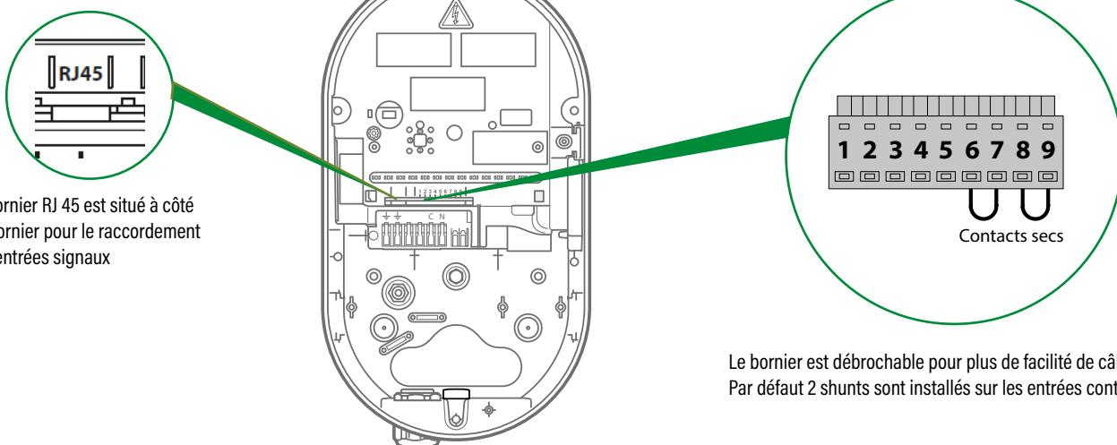
Le bornier RJ 45 est situé à côté du bornier pour le raccordement des entrées signaux
