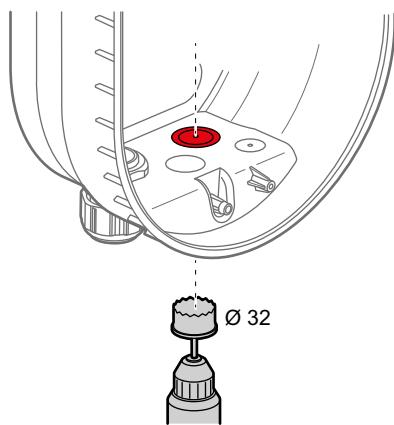
Utiliser un embout passe fil pour obturer une entrée de câbles non utilisée et garantir l'IP55
