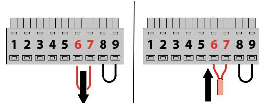
Retirer le shunt des entrées 6 et 7 et raccorder le dispositif de commande (exemple inter horaire)
