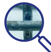
Auréoles blanches sur la soudure
