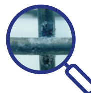
Auréoles blanches sur la soudure
