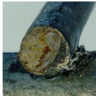
Rouille rouge superficielle sur la coupe
