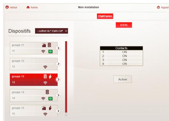
**i** Exemple: l'état du télérupteur apparaît sur l'écran du mini configurateur et la commande est possible à distance.
