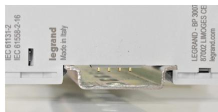
**i** Un module dont la protection à été enlevée peut être utilisé sur un rail DIN simple. Il est conseillé de protéger le module de tout contact en rajoutant une partie isolante de votre choix sur le rail DIN.
