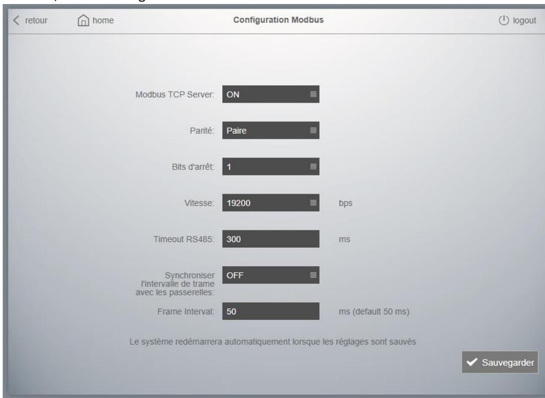
Concernant cet intervalle de trame, il est possible de synchroniser automatiquement cette valeur choisie dans l'énergie web serveur avec les passerelles Modbus/TCP connectées : l'énergie web serveur appliquera cette valeur à toutes les passerelles. C'est la configuration appliquée par défaut, et il est recommandé de sélectionner "OFF » pour cette fonction si les passerelles utilisées sont d'une autre marque.
