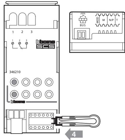
**MOD = 0 - Activación mediante el botón de luces de escalera de cualquier unidad interior y placa exterior (si están equipadas con dicho botón)**
