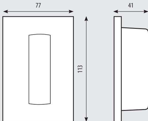
Le dimensioni sono espresse in millimetri. Dispositivo 3 moduli - serie civili.
