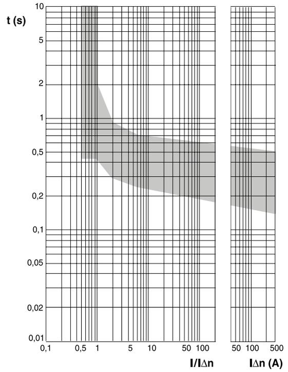
GL/GS déclenchement à 3 secondes - I $\Delta$ n 0,3-1-3A
