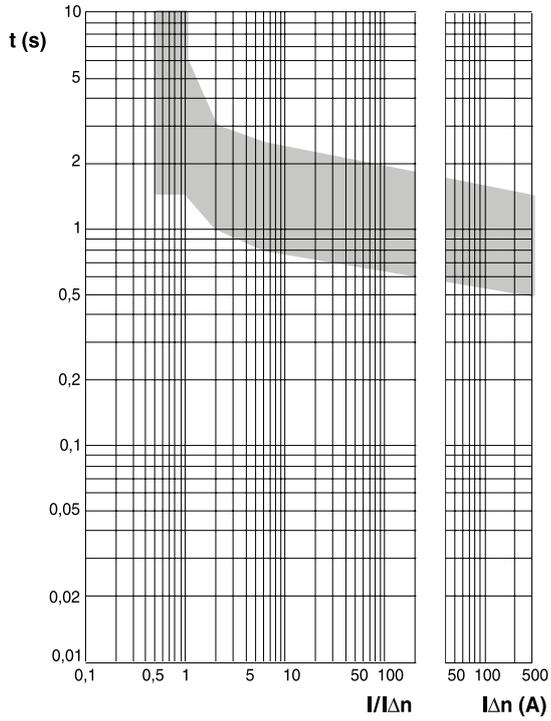
GL/GS déclenchement à 0,3 secondes - I $\Delta$ n 0,3-1-3A
