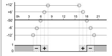
En cas de réglage du décalage en degrés, l'inter horaire commute aux instants où la luminosité est identique, malgré des heures de crépuscule différentes au cours de l'année.
