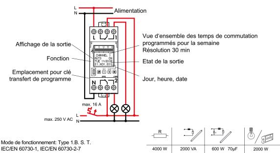
Fonctionnement en environnement courant Montage: Montage dans coffret de distribution, Degré d'encrassement: 2 Sortie logique à contact sec Tension de choc nominale: 4 kV
