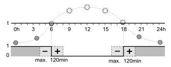
L'horloge commute aux heures calculées de lever et de coucher du soleil. La saisie d'un temps différentiel permet de décaler le moment de la commutation d'un maximum de ±120 minutes par rapport à l'heure de lever et de coucher du soleil.
