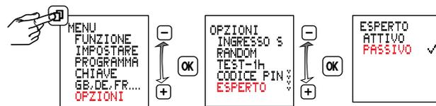
**Attenzione:** Cambiando da ATTIVO a PASSIVO le ulteriori voci di menu vengono nuovamente nascoste e tutte le impostazioni in modalità per esperti vanno perse. Una volta riattivata la modalità per esperti viene eseguita nuovamente con le impostazioni di base.
