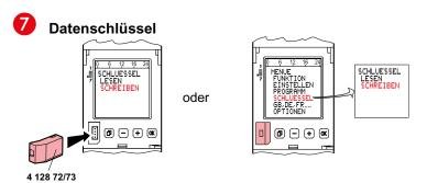
Programme von der Schaltuhr auf einen Datenschlüssel übertragen (SCHLUESSEL SCHREIBEN). Hinweis! Vorhandene Programme des Datenschlüssels werden überschrieben.
