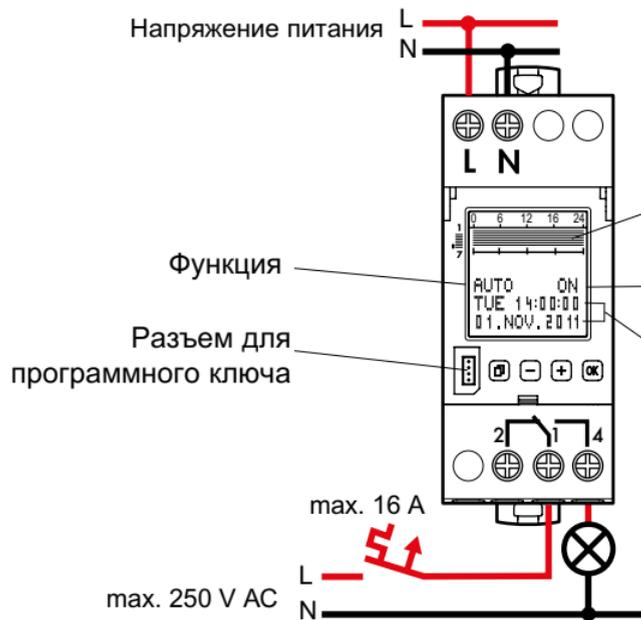
Просмотр недельной программы коммутации нагрузки. Дискретность 0,5 часа
