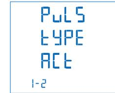
Poids impulsions : 1 imp/10Wh(varh) – 100Wh(varh) – 1kWh(kvarh) - 10kWh(kvarh) - 100kWh(kvarh) – 1MWh(Mvarh) - 10MWh(Mvarh)
