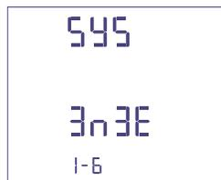
Sélectionner le type de raccordement désirée, en respectant scrupuleusement le schéma de raccordement associé.
