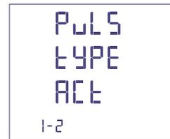
**Poids impulsions:** 1 impulsion/10Wh(varh) - 100Wh(varh) - 1kWh(kvarh) - 10kWh(kvarh) - 100kWh(kvarh) - 1MWh(Mvarh) - 10MWh(Mvarh)
