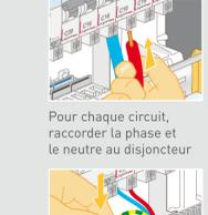
Pour chaque circuit, raccorder la phase et le neutre au disjoncteur
