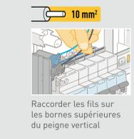
**3** Raccorder les circuits aux disjoncteurs et à la terre
