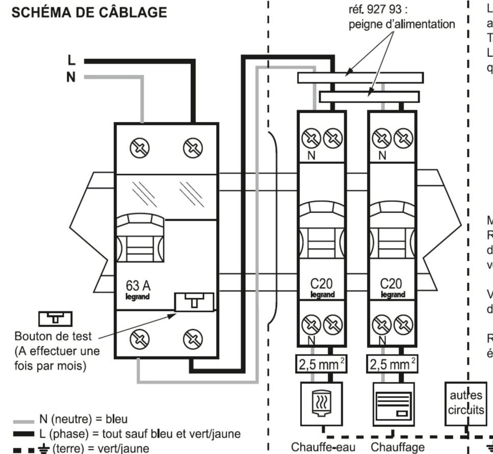
L'interrupteur différentiel doit être protégé en amont, soit par un disjoncteur de branchement Tarif bleu (ex. BACO), soit par un disjoncteur Legrand (ou un fusible gG) de même calibre que l'interrupteur différentiel.
