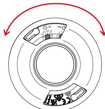
Potentiomètre du réglage du niveau de luminosité
