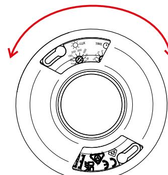
Potentiomètre du réglage du niveau de luminosité
