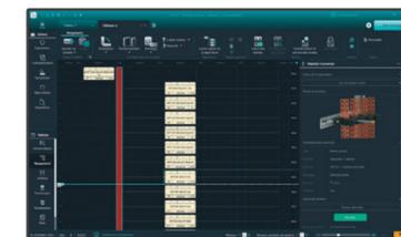
Le module **rangement** permet d'organiser le positionnement des différents appareils de protection et de déterminer le type de répartition souhaité. Le schéma électrique correspondant s'affichera dans le module **schéma**.
