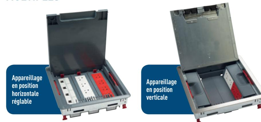
Trois tailles de boîtes de sol et deux positions de montage. Le choix est fait en fonction du nombre de prises nécessaires, de l'utilisation souhaitée et de la hauteur disponible dans le sol : 12/18/24 modules pour les prises en position horizontale et 8/12/16 modules pour les prises en position verticale.
