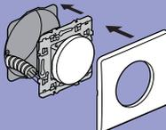
2) Raccorder les fils, monter le mécanisme et la plaque
