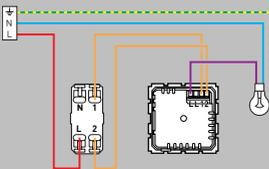
Contacteur de puissance réf. 040 49 au tableau électrique
