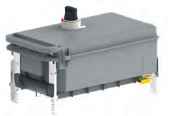
Coffret fibre de verre (isolation totale : pas de pièces métalliques entre l'intérieur et l'extérieur)
