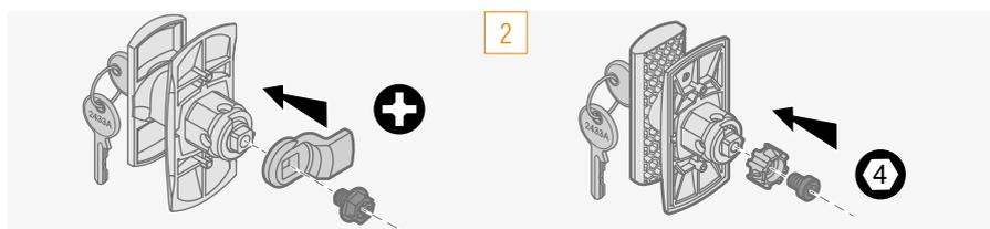
1. Clipper l'adaptateur à l'arrière du barillet.
