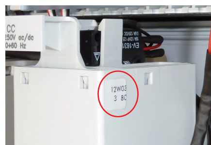
Sur l'ensemble des accessoires, la date de fabrication est reportée sur un petit autocollant, ainsi que sur l'étiquette de son emballage.
