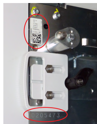
Sur le flanc droit du DMX 3 , la fin du numéro de série est gravée sur la structure métallique et est indiquée en entier, avec la date de fabrication sur une étiquette autocollante.
