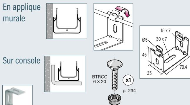
Assemblé à une console équerre CEQ (ci-dessous), avec boulons BTRCC 6 x 12 (p. 234), le berceau peut être utilisé en suspente
