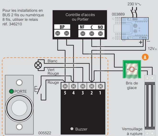
**A** Montage de ce produit en conformité avec la réglementation incendie en vigueur
