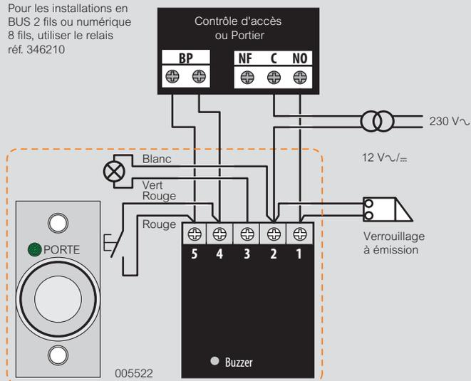
**Schéma de raccordement des boutons-poussoirs réf. 005511 et 005522 à une ventouse ou à une gâche à rupture**
