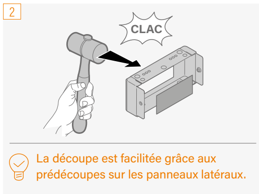
2. Défoncer les plinthes à poser sur la profondeur de l'armoire.
