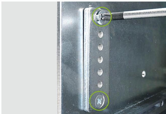
Mettre en place les ensembles vis/rondelles dans la plaquette (3 sur le bas dans notre exemple) et effectuer le serrage
