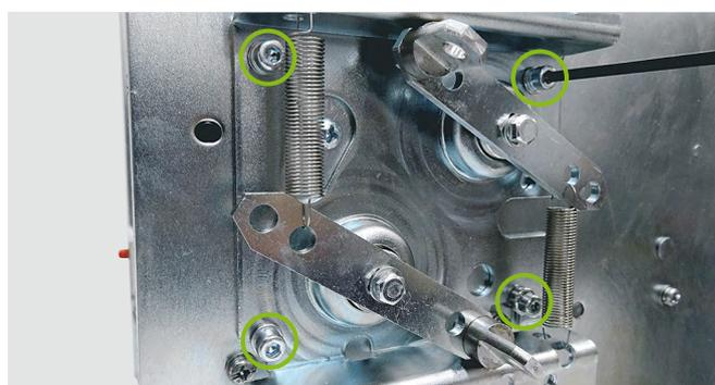
Fixer le support métallique sur la plaque avec les 2 leviers à l'aide des 2 vis et des rondelles fournies: empreinte 6 pans de 4 mm, couple de serrage de 3 Nm.
