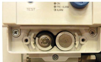
Le compartiment batteries, situé sous l'unité de protection électronique est accessible en face avant.
