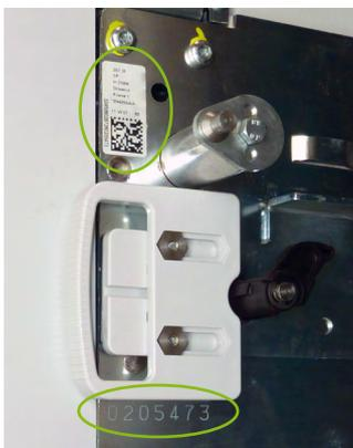
Sur le flanc droit du DMX-SP, la fin du numéro de série est gravée sur la structure métallique et est indiquée en entier, avec la date de fabrication sur une étiquette autocollante.
