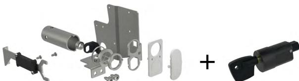
Cet accessoire permet le verrouillage dans les positions « embroché, test et débroché ». Une pièce fournie avec le kit permet par sa présence, d'interdire le verrouillage en position embroché. Il est préférable de toujours installer cette pièce, et donc d'interdire le verrouillage en position « embroché », et éventuellement de la retirer par la suite.
