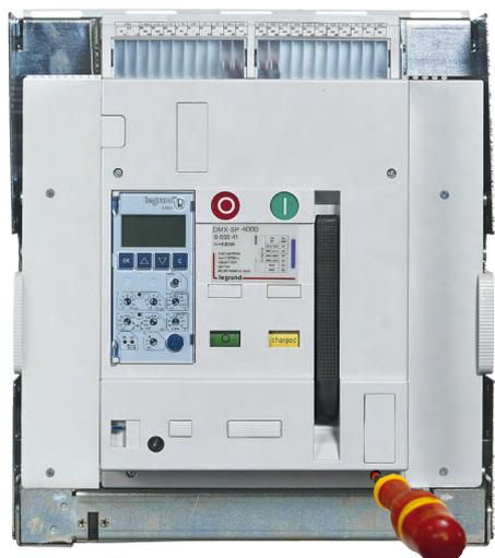
Pour verrouiller le DMX-SP débrochable en position « test » et/ ou en position « débroché », tourner la clé d'1/4 de tour vers la droite après s'être assuré que la manivelle soit retirée du système d'embrochage, et que son logement soit obturé.
