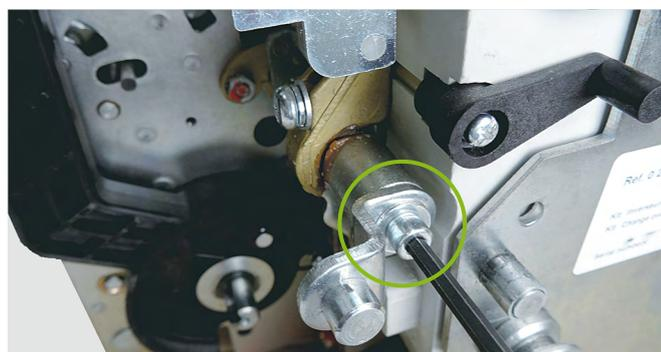
Fixer la plaque avec les 2 leviers sur le côté droit de la base à l'aide des 4 vis et des rondelles fournies: empreinte 6 pans de 3 mm, couple de serrage de 2 Nm.
