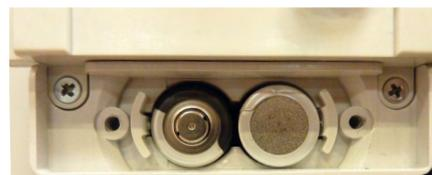
Le compartiment batteries, situé sous l'unité de protection électronique est accessible en face avant.
