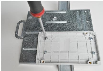
Fixer ensuite le support du moteur sur l'adaptateur (ici pour un DPX<sup>3</sup> 250, la plaque de rattrapage de largeur n'est pas nécessaire).
