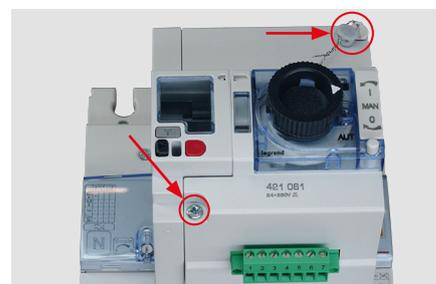
Fixer le moteur sur son embase à l'aide des 2 vis en diagonale. Un cache-vis plombable peut être mis en place sur l'une des 2 vis.
