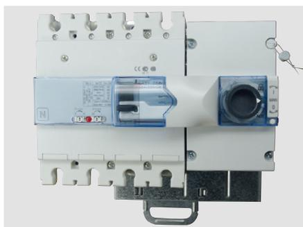
Tout comme pour la commande motorisée frontale, il est possible de manœuvrer manuellement le disjoncteur à l'aide de la clé insérée sur la commande motorisée latérale. Il faut mettre le bouton rotatif sur la position manuelle, positionner la clé dans l'orifice et tourner celle-ci pour ouvrir ou fermer le disjoncteur.
