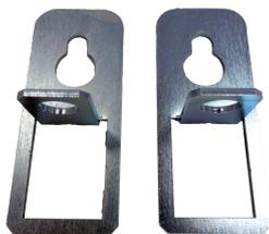
1. Fixer les 4 pattes sur l'enveloppe à l'aide des vis M12 têtes bombées fournies avec l'enveloppe : clé 6 pans de 8 mm → couple de serrage 8 Nm.
