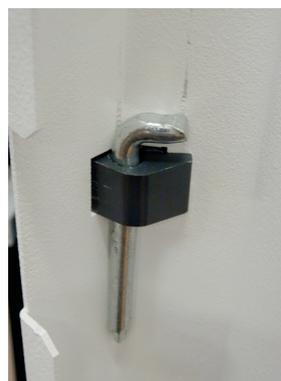
4. Fermer la porte et effectuer un essai de fermeture.
