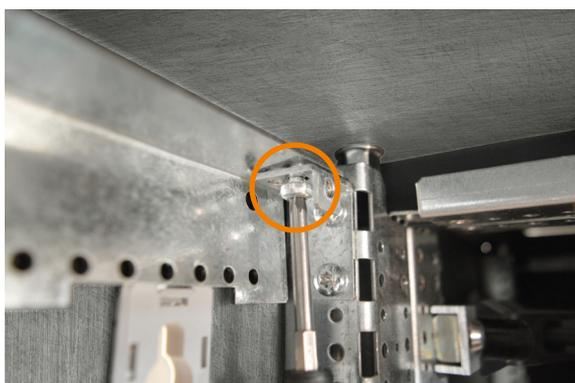
5. Mettre en place la patte-support du haut du montant de la gaine à câble interne, les équerres de la traverse du bas, la patte-support du bas du montant de la gaine à câble interne et enfin la traverse complète sur les équerres.
