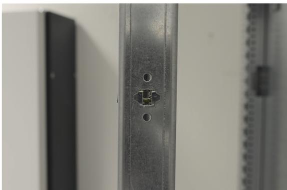
1. Mettre en place les 6 écrous-cage dans les trous carrés de l'enveloppe (côté charnières).
