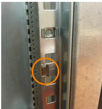
4. Fixer le plastron en serrant les vis → Pozidriv n° 3, couple de serrage de 5 Nm.
