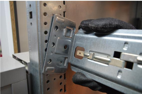
3. Insérer l'ensemble équerres/rail dans les 2 pattes dans la position la plus reculée suivant le type de produit installé sur le rail. Cette opération s'effectue en actionnant les 2 languettes flexibles vers l'extérieur. Il est possible de mixer les produits sur une même rangée, des réhausses seront nécessaires dans ce cas (voir page suivante).
