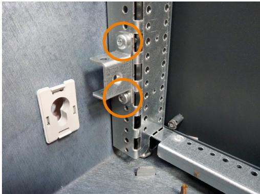
1. Fixer la traverse sur les pattes (1 vis/patte, clé Torx T30, couple de serrage 8 Nm).
