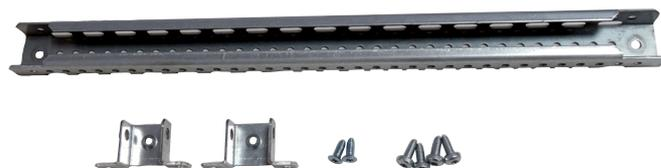
Installer les pattes de fixation des traverses sur les montants fonctionnels (2 vis/patte, clé Torx T30, couple de serrage 8 Nm).
