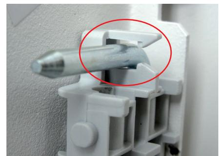
L'axe doit être clipsé correctement dans le logement prévu (voir photo ci-dessus).
