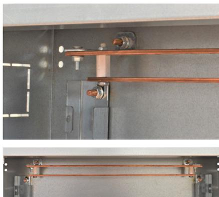
Pour l'installation d'un bornier IP 2X, nous devons utiliser un barreau plat 12x2 mm réf. 0 048 19. Ce barreau se fixe également sur les pattes livrées avec le coffret. Pour cela il faut le couper et le percer.
