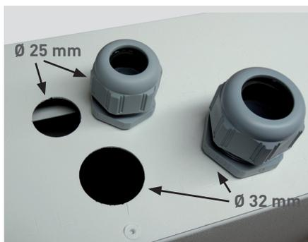
Il est possible de découper des zones rectangulaires pour faire circuler plusieurs câbles. Les coins sont pré-marqués sur les flancs haut et bas du coffret, la découpe s'effectue à l'aide d'une scie sauteuse ou d'un emporte pièce.
