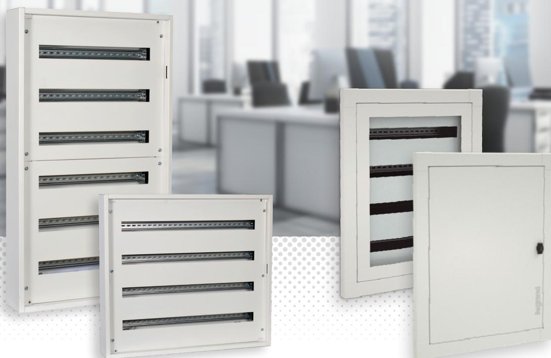
Les coffrets **XL<sup>3</sup> S 160** sont des coffrets « tout modulaire » prêts à l'emploi, de 2 à 8 rangées de **24 modules** et de 4 à 8 rangées de **36 modules** livrés avec rails et plastrons toutes hauteurs montés.
