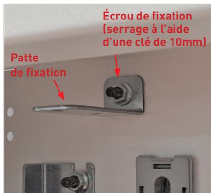
Utiliser ensuite le barreau laiton réf. 0 373 00 qui se fixe sur les pattes livrées avec le coffret (à l'aide des 2 vis et 2 écrous fournis avec la réf. 0 373 00). 4 positionnements dans le coffret sont possibles → 2 en haut et/ou 2 en bas.
