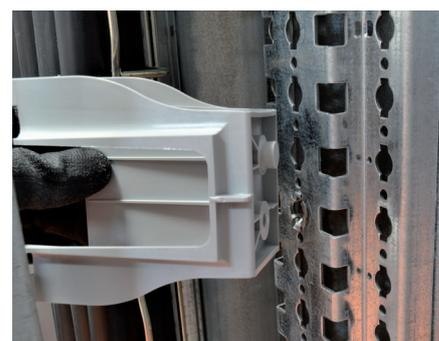
Le bracelet de circulation verticale réf. 0 201 93 est monté au moyen d'un clips-écrou et d'une vis isolante M6. Il est fixé sur la partie haute des montants fonctionnels
