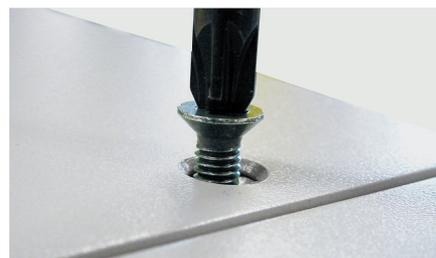
Les façades avant et arrière du socle sont fixées à l'aide de quatre vis autotaraudeuses.
