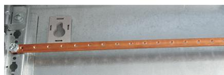
Les connecteurs spécialement conçus pour la barre cuivre à trous taraudés réf. 0 373 65, permettent le raccordement des conducteurs de section 1,5 à 10 mm<sup>2</sup>
