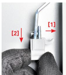
Dégager les deux bagues de liaison des tringles et du mécanisme.
