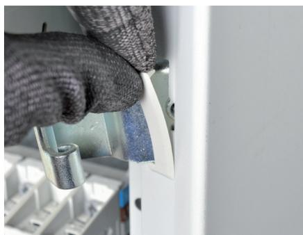
Pour une finition optimum, insérer les caches de finition dans le passage de la charnière.
