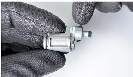
Associer l'ensemble cage d'adaptation et barillet avec l'adaptateur de couleur aluminium.
