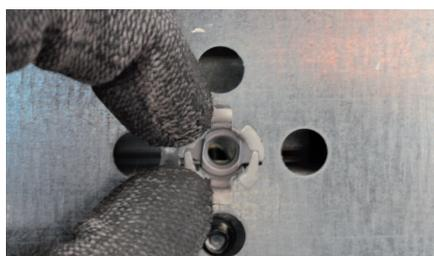
Enlever le cache plastique à l'arrière de l'armoire et mettre en place du clip-écrou
