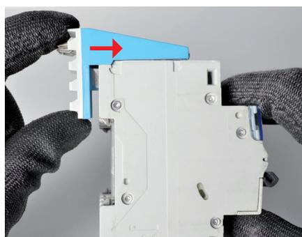
Positionner la partie haute du module de connexion (marquée "Max 80") sur le dessus du disjoncteur puis pousser vers l'avant pour enfoncer la broche du module dans le dispositif plug-in de l'appareil. Ce dernier garantit une pression de contact correcte.
