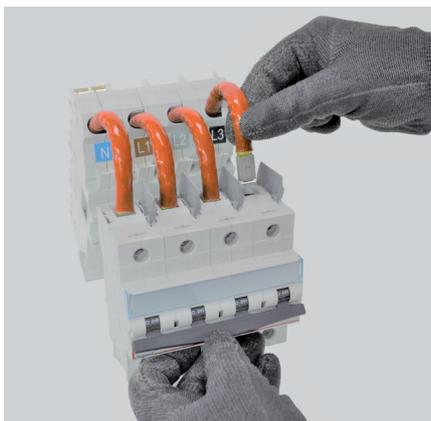
Raccorder les fils dans le disjoncteur sans l'installer sur la partie "rail" de la base support.
