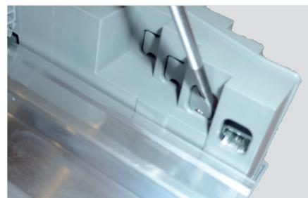
L'alimentation d'une rangée à l'autre sera réalisée en cassant les obturateurs situés sous la tête d'alimentation.
