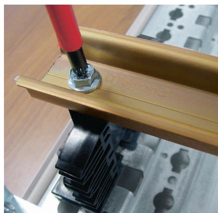
Une autre solution consiste à fixer un rail sur les supports isolants réf. 0 200 90
