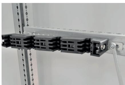
Fixer les supports sur les traverses à l'aide des vis M6 (serrage 10 Nm)
