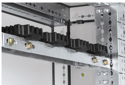
Fixer les supports sur les montants à l'aide de 4 clips-écrous + vis (serrage 10 Nm)
