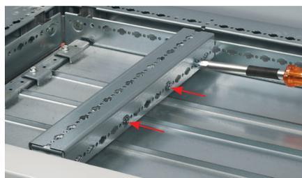
Fixer la traverse sur les équerres puis insérer quatre clips écrous dans les 5<sup>e</sup> et 9<sup>e</sup> trous des traverses.
