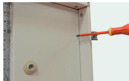
Fixer la façade sur les charnières à l'aide des vis à tête fraisée fournies puis insérer les caches en plastique dans les têtes des vis pour parfaire la finition.
