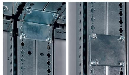
Si le tableau doit être déplacé ou transporté, il est nécessaire de renforcer la structure après jumelage à l'aide des plaques de renforcement réf. 0 205 88/89. (voir page 76).
