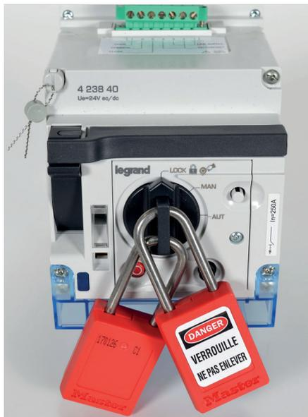
Les commandes motorisées peuvent être accessorisées avec un verrouillage à clé réf. 4 238 45, (barillets identiques aux commandes rotatives déportées, réf. : 4 238 80, 4 238 81, 4 238 82, 4 238 83) ou une référence de cadénassage réf. 4 238 46 permettant de mettre jusqu'à 3 cadenas de diamètre 8 mm maxi.
