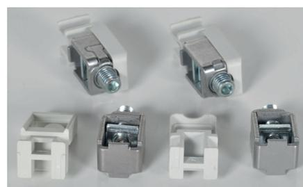
La capacité de ces bornes est de 14 mm de largeur, pour des câbles de 2,5 mm<sup>2</sup> minimum à 50 mm<sup>2</sup> maximum pour un couple de serrage de 8 Nm. Elles sont préconisées pour des câbles cuivre uniquement.
