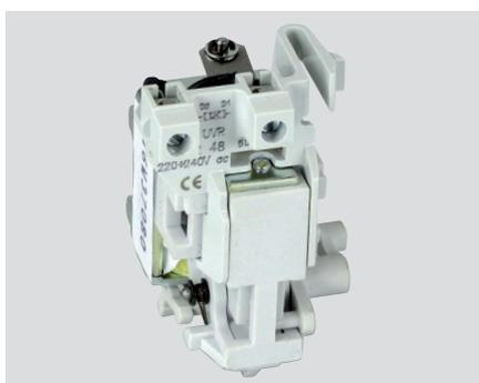
Les déclencheurs à minimum de tension permettent l'ouverture instantanée ( $\leq 50$  ms) de l'appareil par la coupure de l'alimentation ( $< 85\% U_n$ ) de leur bobine : sécurité positive (ex : arrêt d'urgence par contact externe NF).
