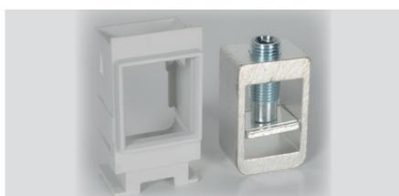
La capacité maximum de ces bornes est de 18 mm de largeur. La section des câbles souples est de 2,5 mm<sup>2</sup> minimum à 120 mm<sup>2</sup> maximum. La section des câbles rigides est de 2,5 mm<sup>2</sup> minimum à 150 mm<sup>2</sup> maximum. Le serrage est effectué à l'aide d'une clé 6 pans de 5 mm, le couple est préconisé à 10 Nm. Elles sont compatibles avec des câbles cuivre ou aluminium et peuvent être montées en amont et/ou aval du disjoncteur.
