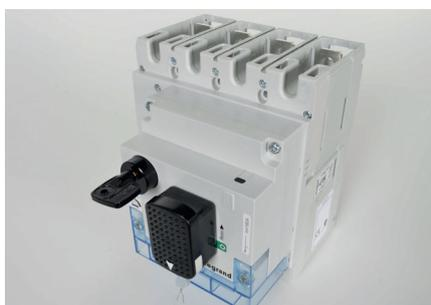
Un autre accessoire est disponible pour ces commandes rotatives directes, un jeu de 2 contacts inverseurs NO/NC (réf. 4 238 06). Il se monte à l'intérieur du boîtier, avant la fixation de celui-ci sur le disjoncteur. Enlever la partie plastique sur le dessus du support de la commande rotative directe et insérer les 2 contacts et leur connecteur sur la commande.
