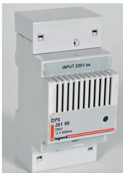
Ces modules servent à retarder l'ouverture du disjoncteur, associé avec le déclencheur réf. 4 210 98, de 800 ms et ainsi empêchent les déclenchements intempestifs en cas de microcoupures sur le réseau. Le câblage s'effectue en parallèle. 2 tensions sont disponibles : 230 volts et 400 volts.
