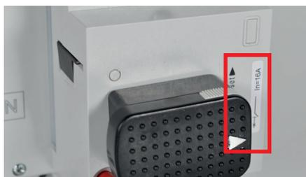
Les commandes rotatives sont cadenassables au niveau de la poignée, par 3 cadenas maximum, de diamètre 3 mm minimum à 8 mm maximum. Il suffit de sortir la languette située dans la poignée et d'insérer les cadenas.
