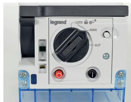
Les commandes électriques ou à distance sont désactivées. La manette frontale permet de charger le ressort manuellement. Le bouton noir (I) permet de fermer le DPX<sup>3</sup> et le bouton rouge (O) permet de l'ouvrir.
