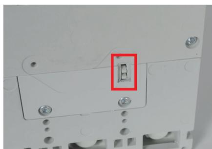
Fixer le disjoncteur sur la base mobile avec 2 vis pour un DPX<sup>3</sup> 3 pôles et 4 vis pour un DPX<sup>3</sup> 4 pôles, puis installer les 2 blocs de prises de raccordement, amont et aval, en approchant les 4 vis simultanément, puis les serrer au couple de 10 Nm. Mettre en place les caches-vis qui peuvent être plombables.
