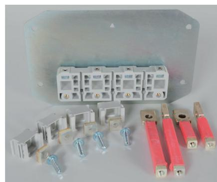
Elles permettent de raccorder un disjoncteur fixe ou une base extractible, à l'arrière de ceux-ci. Elles se montent directement sur le disjoncteur ou sur la base, à l'aide de la petite platine pour solidifier le montage. Le cache borne dédié peut être plombable. Elles peuvent être installées en amont et/ou en aval. 4 vis de maintien de ces prises arrière (une par tôle) sont prévues pour éviter une flexion trop importante.
