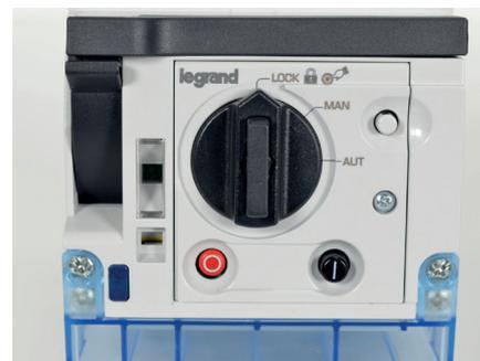
Le sélecteur est placé en position « LOCK » en appuyant simultanément sur le bouton rouge (O). Il est impossible de piloter électriquement ou manuellement la commande motorisée, cette position n'est possible que si l'appareil est en position ouverte (OFF). En mode « LOCK », il est possible de cadenasser la commande motorisée avec 3 cadenas maximum de diamètre 6 mm maxi.
