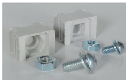
Suivant le calibre des disjoncteurs, ils sont livrés avec des bornes à vis différentes : soit avec des écrous carrés de 6 mm ( $\leq 125$  A) pour un couple de serrage de 7 Nm, soit avec des écrous hexagonaux de 8 mm ( $> 125$  A) pour un couple de serrage de 10 Nm.
