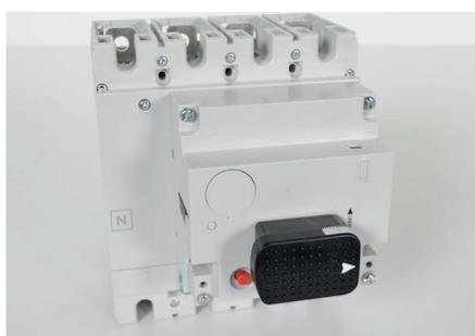
Visser la partie basse de la commande rotative, et installer le plombage si nécessaire. La commande est prête à fonctionner. Penser à coller les 2 autocollants, indiquant le bon calibre du disjoncteur et les réglages effectués, car les inscriptions sont dissimulées derrière la commande rotative.
