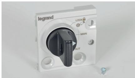
Ces accessoires se fixent en lieu et place de la face avant de la commande motorisée. Ils peuvent être plombés au niveau de la face avant. Mettre le moteur en position manuel (MAN), dévisser la face avant et la remplacer par l'un des accessoires. Il faut au préalable insérer le barillet désiré sur le verrouillage à clé.
