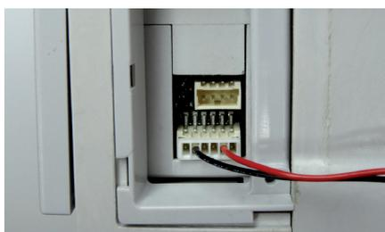
**i** Attention, les disjoncteurs électroniques DPX<sup>3</sup> 630 de type S1 ne permettent pas l'ajout d'une alimentation externe.
