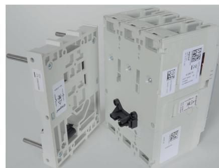
La base mobile permet de fixer le disjoncteur et de pouvoir le rendre extractible par rapport à la base fixe. Lors de l'extraction du disjoncteur de la base fixe, il se met automatiquement en position « déclenchée » si celui-ci est fermé.
