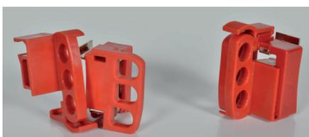
Cet accessoire permet de condamner, l'ensemble de la gamme des DPX<sup>3</sup> 125 HP, en cadénassant leurs manettes. Il est possible d'installer 3 cadenas maximum, de diamètre 3 mm minimum à 8 mm maximum. Il est composé de 2 pièces distinguées, une à accrocher sur les DPX<sup>3</sup> et l'autre à fixer sur la première partie.
