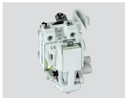
Les déclencheurs à minimum de tension permettent l'ouverture instantanée ( $\leq 50\text{ms}$ ) de l'appareil par la coupure de l'alimentation ( $< 85\% \text{Un}$ ) de leur bobine : sécurité positive (ex : arrêt d'urgence par contact externe NF).
