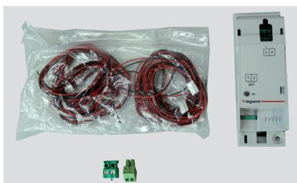
Elle permet d'alimenter les unités électroniques des DPX<sup>3</sup> lorsque le disjoncteur n'est pas sous tension ou lorsque le courant qui le traverse est trop bas. Elle permet également d'alimenter plusieurs disjoncteurs (sortie maximum 250 mA) et d'avoir toutes les fonctions "mesure" actives. Les flancs munis d'un connecteur spécifique sont fournis et se connectent sur le côté des disjoncteurs.
