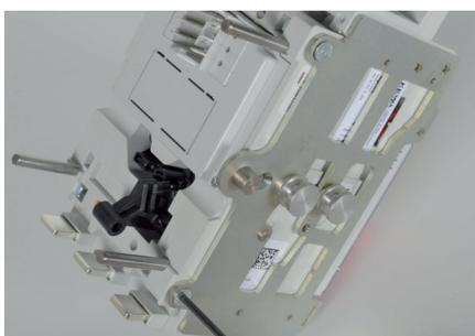
Le système peut fonctionner, le disjoncteur peut être embroché ou débroché avec la manivelle fournie. Il peut être équipé de cadenas à placer sur le système en tirant sur la manette située sous le bloc débrochable uniquement lorsque le disjoncteur est débroché. Il est possible d'installer 3 cadenas maximum, de diamètre 5 mm minimum, et 8 mm maximum.
