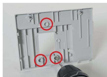
Enlever et jeter la partie plastique bleutée de la face avant et percer cette dernière de 3 trous de diamètre 4,5 mm.
