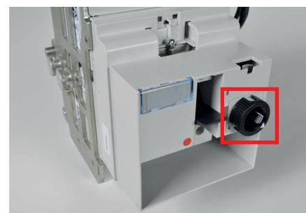
Le montage de l'accessoire de verrouillage à clé, pour le bloc débrosable, est aussi possible sur la face avant. Ce verrouillage se met en lieu et place du verrouillage livré monté. Ils permettent de condamner le disjoncteur en position ouvert. L'installation de ces verrouillages s'effectue avant la mise en
