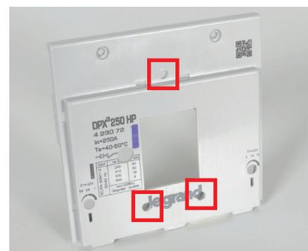
Le montage est identique aux commandes rotatives directes (voir pages 45 et 46) en perçant la face avant du disjoncteur de 3 trous de 4,5 mm et en ôtant et jetant la partie plastique bleutée de la face avant du disjoncteur.
