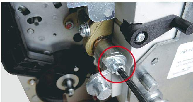
Fixer la plaque avec les 2 leviers sur le côté droit de la base à l'aide des 4 vis et des rondelles fournies : empreinte type Allen de 3 mm, couple de serrage de 2 Nm.
