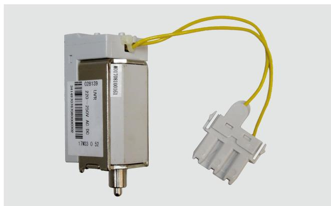
Le déclencheur à minimum de tension permet l'ouverture instantanée du DMX-SP par coupure de l'alimentation de la bobine : sécurité positive.
