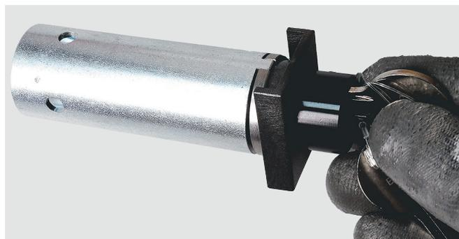
Mettre en place la came plastique fournie et la bloquer avec l'écrou métallique à l'aide d'une clé plate de 16 mm (couple de serrage de 4 Nm).
