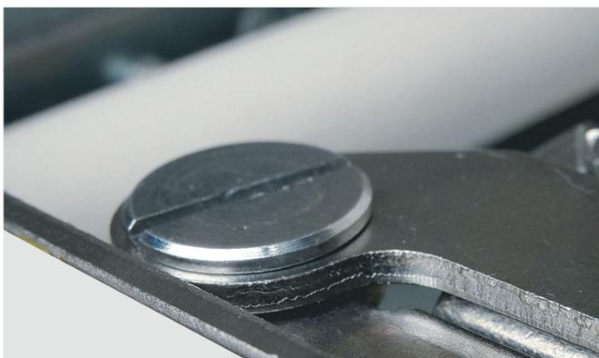
Réinsérer le cadre plastique par le devant en engageant correctement le bouton dans le trou préalablement percé.
