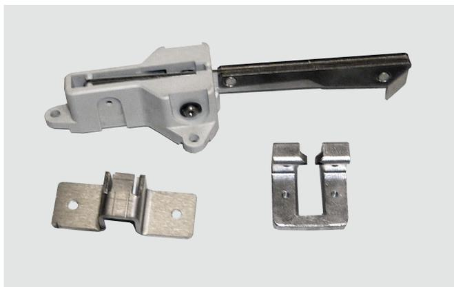
Ce verrouillage permet d'interdire l'ouverture du plastron sur charnières ou de la porte quand le DMX-SP débrochable est en position « embroché ». L'ouverture du plastron est possible dans la position « débroché ».
