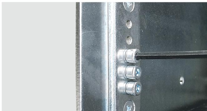
De la même manière, fixer la plaquette restante sur le côté gauche du DMX-SP à l'aide des 2 vis tête fraisée restantes (empreinte Phillips n°1, couple de serrage de 3 Nm). Les trous chanfreinés de la plaquette doivent être positionnés côté extérieur du DMX-SP.
