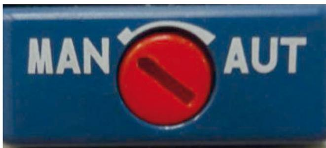
Le DMX-SP est livré avec le sélecteur dans cette position. Dans cette configuration, il est possible d'empêcher la fermeture du disjoncteur après un déclenchement commandé par l'unité de protection (le bouton est sorti). Avant de pouvoir refermer le disjoncteur, l'opérateur doit enfoncer le bouton de reset jusqu'à son maintien.
