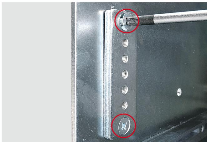
Mettre en place les ensembles vis/rondelles dans la plaquette (3 sur le bas dans notre exemple) et effectuer le serrage → empreinte type Allen de 3 mm, couple de serrage de 3 Nm.
