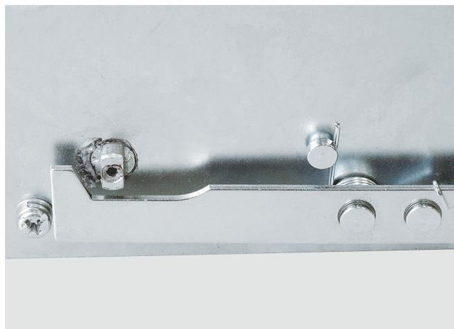
Insérer le clip de maintien puis la came avec sa vis (embout empreinte Phillips n°2, couple de serrage de 3 Nm)
