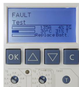
Quand la charge de la batterie est insuffisante, l'unité de protection indiquera par un message texte ou par une icône, le remplacement de la batterie.
