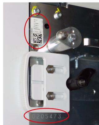
Sur le flanc droit du DMX<sup>3</sup>, la fin du numéro de série est gravée sur la structure métallique et est indiquée en entier, avec la date de fabrication sur une étiquette autocollante.
