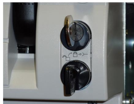
**i** Les deux emplacements disponibles sur les verrouillages à clé assurent le même verrouillage.
