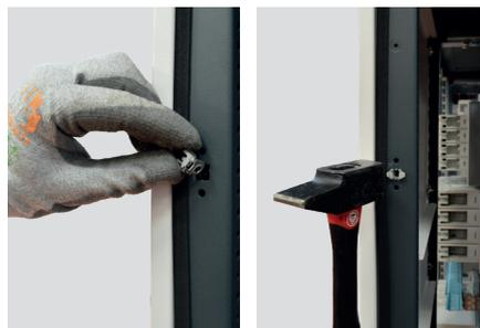
Assembler un bandeau vertical avec un bandeau horizontal en veillant à insérer correctement l'ergot dans la fente :
