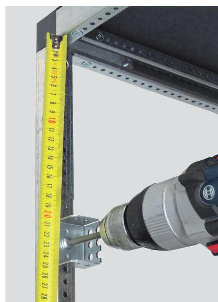
Insérer la traverse dans les 2 pattes puis la fixer à l'aide de 2 vis Torx T30 (couple de serrage de 5 Nm.).
