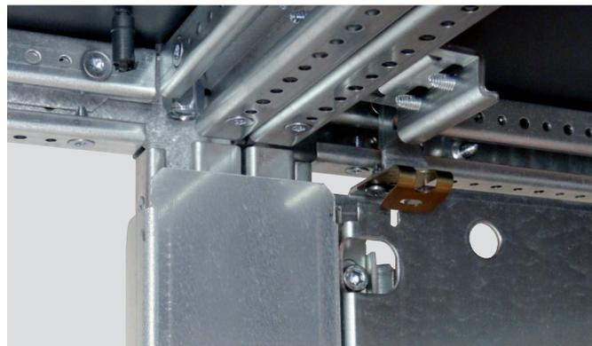
Fixer la plaque intermédiaire par l'arrière à l'aide des vis fournies en passant par les orifices des plaques pleines : tête hexagonale de 10 mm, couple de serrage de 5 Nm.
