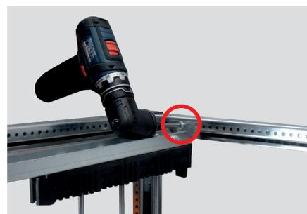
**!** Pour la réalisation d'un jeu de barres derrière montants fonctionnels, les supports réf. 3 399 20/21 s'installent dans l'enveloppe avec la patte fournie préalablement fixée sur le montant de structure arrière à l'aide d'une vis Torx fournie → outil T30, couple de serrage de 8 Nm. Le support est ensuite fixé à l'aide de la vis Torx restante, et de la vis et de l'écrou M6 fournis du côté patte → outil T30, couple de serrage de 8 Nm - clé hexagonale de 10 mm, couple de serrage de 10 Nm.
