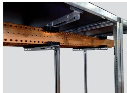
Pour réaliser un jeu de barres principal horizontal en fond d'enveloppe (prof. 600 ou 800 mm), les supports fixes réf. 3 399 29 s'installent sur les traverses de la même manière que les montages expliqués ci-dessus. Cependant, les supports seront toujours équipés avec la grande glissière en position « fixation 600 mm » (voir photo page 14).
