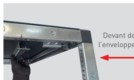
Vérifier que le trou se situant vers le devant de l'enveloppe se situe à 175 mm de l'intérieur du montant de structure avant de l'enveloppe.
