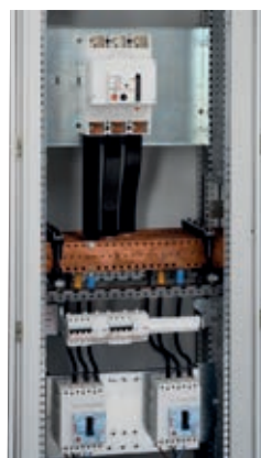
Vloerkast ref. 047253 zonder XL 3 afdekplaat, steunkader afdekplaten ref. 047482 en stijprofielen ref. 047480
