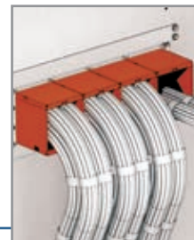
Solution multiple pour mur avec plaque de recouvrement pour 1 à 5 modules. Pour câbles de Ø 21 mm maximum.
