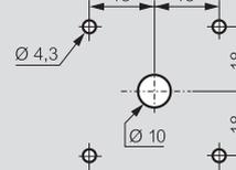
Perçage panneau pour fixation centrale encastrée Ø22 mm
