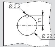
Perçage panneau pour commande rompue
