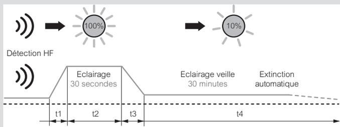
Les temps t1, t2, t3 et t4 sont paramétrables avec l'outil de configuration réf. 088230
