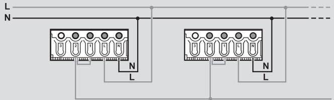
⚠ L'entrée commande 2 doit être configurée en interrupteur.
