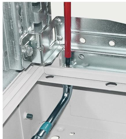
Fixer les deux côtés du socle à l'aide des quatre vis M6 et des quatre écrous fournis.
