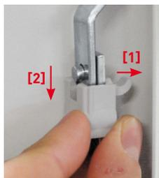
Dégager les deux bagues de liaison des tringles et du mécanisme.
