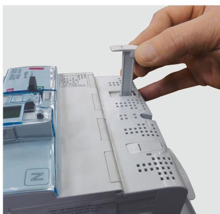
Verrouiller le cache-bornes en insérant les 2 bouchons plombables.
