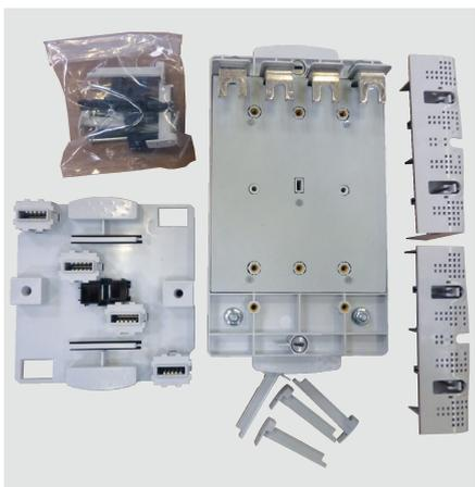
Les bases supports pour DPX<sup>3</sup> sont composées d'une partie fixe, d'une partie mobile, d'un kit anti-extraction et de deux cache-bornes. Elles permettent la connexion automatique d'un DPX<sup>3</sup> 160 ou 250 (hors charge) sur le répartiteur de rangée en présence de tension.
