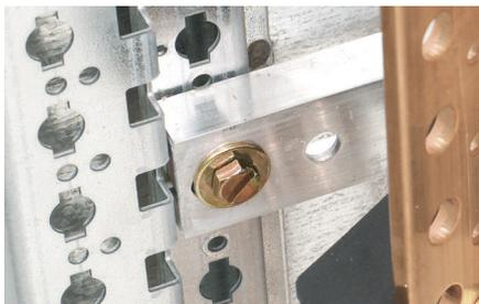
Fixer les supports sur le profil bas des montants fonctionnels à l'aide de clips-écrous et de vis M6 (serrage 10 Nm).
