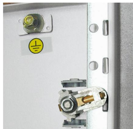
**+** La liaison équipotentielle des plastrons  $\frac{1}{4}$  de tour est assurée par le pêne de verrouillage, la borne de terre est prévue uniquement pour le cas du montage d'appareils sur le plastron.
