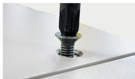
Les façades avant et arrière du socle sont fixées à l'aide de quatre vis autotaraudeuses.
