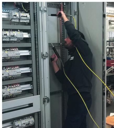
Exemple : essai diélectrique à fréquence industrielle
