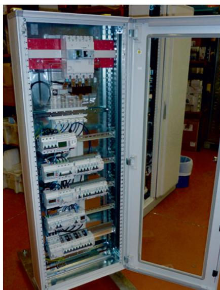
Exemple : test de fonctionnement sur portes, plastrons, verrouillages, etc.
