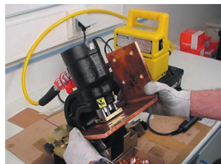
La poinçonneuse hydraulique permet des perçages de précision, sans copeaux et sans effort.
