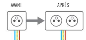
Les kits s'installent en lieu et place d'une simple prise en utilisant les mêmes fils
