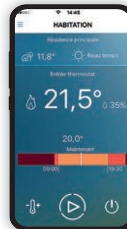
Une interface de pilotage simple et intuitive pour gérer le chauffage à distance, créer et modifier des scénarios de température, activer la fonction "Boost"
