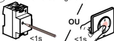
**Appuyer brièvement** sur le bouton de configuration du module Control (ou au centre de la commande générale sans-fil Départ/Arrivée) pour finaliser l'installation.
