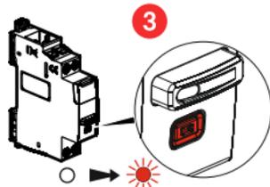
**3** Appuyer sur le bouton de configuration du module Control, **OU** au centre de la commande générale jusqu'à ce que le voyant s'allume brièvement en vert, **puis relâcher l'appui**.
