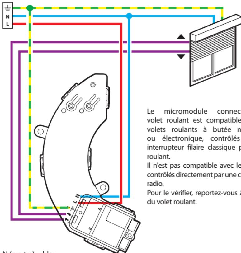
Le micromodule connecté pour volet roulant est compatible avec les volets roulants à butée mécanique ou électronique, contrôlés par un interrupteur filaire classique pour volet roulant.
