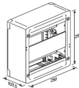
Les coffrets de communication ont un entraxe de fixation de 217mm en 13 modules.
