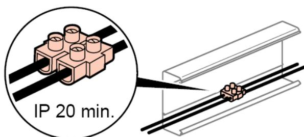
A l'intérieur des profilés, connexion des conducteurs à l'aide de « domino » pour respecter l'IP 20 mini.
