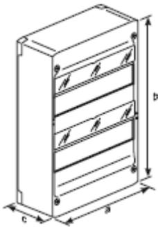
Les coffrets saillies 1 à 4 rangées ont un entraxe de fixation de 217mm en 13 modules et 322mm en 18 modules.
