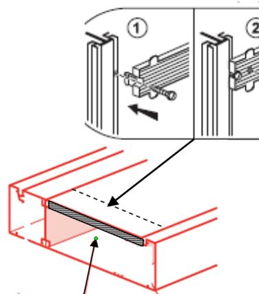
Le couvercle mis en place repose sur le support universel pour maintien de l'IP.
