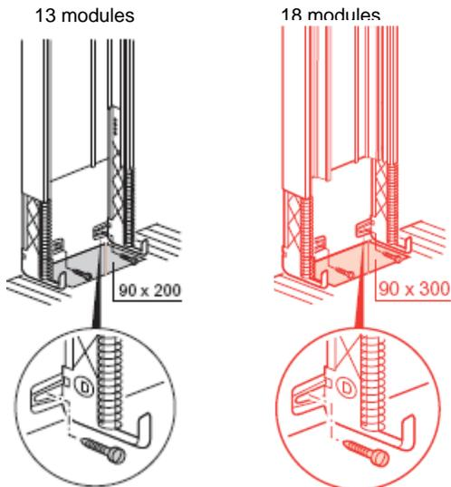
Fixation de la goulotte pré-percée au mur et fixation des pieds compensateurs au mur à l'endroit indiqué
