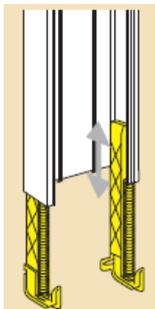
L'installation du pied compensateur permet un réglage en hauteur compris entre 2450 et 2600mm
