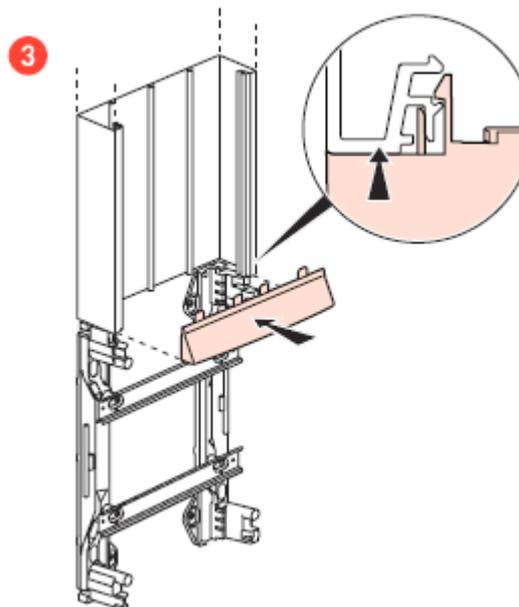
Mise en place du couvercle dans le cornet et clipsage sur la goulotte puis vissage du capot du tableau sur la platine.
