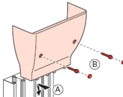
A= fixer sur le couvercle sur la goulotte puis insérer le cornet (les clips prennent sous le couvercle)
