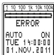
Aucun capteur connecté, rupture de câble ou court-circuit
