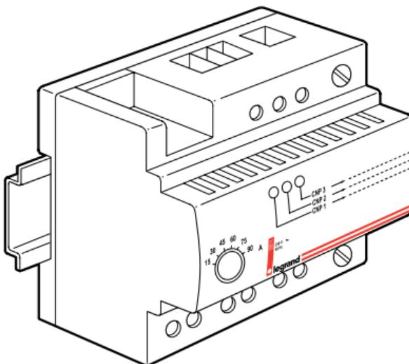
Le délesteur permet d'éviter des déclenchements du disjoncteur malgré un calibre inférieur à celui qui serait normalement utilisé.
