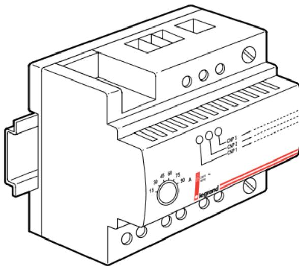
El selector de consumo permite evitar los disparos del I.C.P., aún con un calibre inferior al que se utilizaría normalmente.
